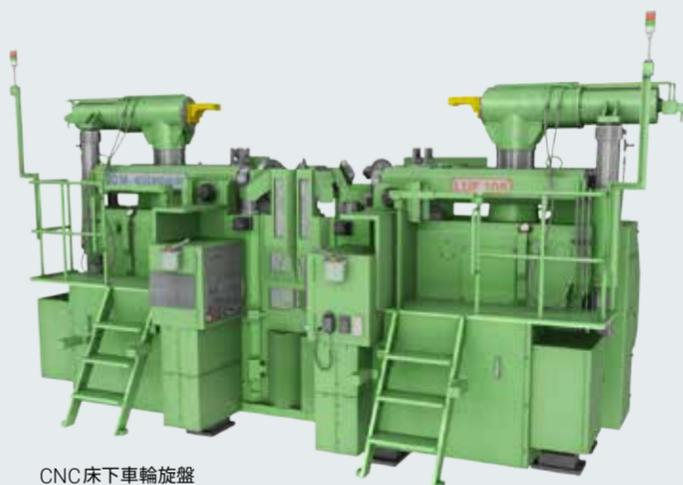
CNC床下車輪旋盤
