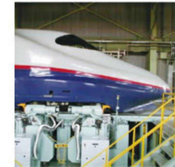
OM：新幹線等の車輪をメンテナンスする床下車輪旋盤も国内シェアNo.1
