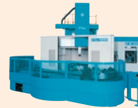
※立旋盤（たてせんばん） 垂直軸を中心にして、水平に回転するテーブルをもち、その上に工作物を取り付け、外周を刃物で切削する機械
